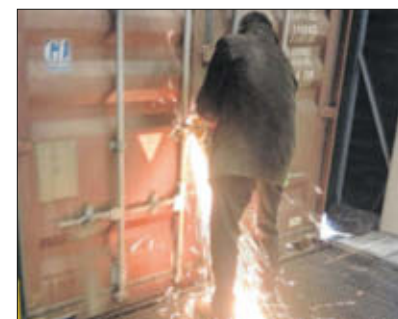
Legal werden Container durch Bolzen-Ausschweißen geöffnet.
