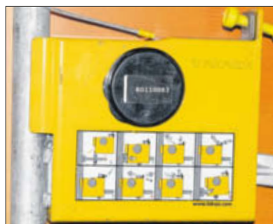
So sieht das Trakalok-System aus, das die Container absichert.
